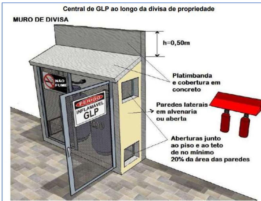
Figura 7: Central de Gás
